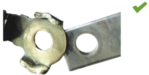
Afb. 2: Massaverbinding na de reiniging: contact goed
