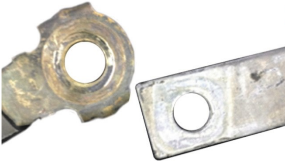
Afb. 1: Massaverbindingen voor de reiniging: contact slecht
