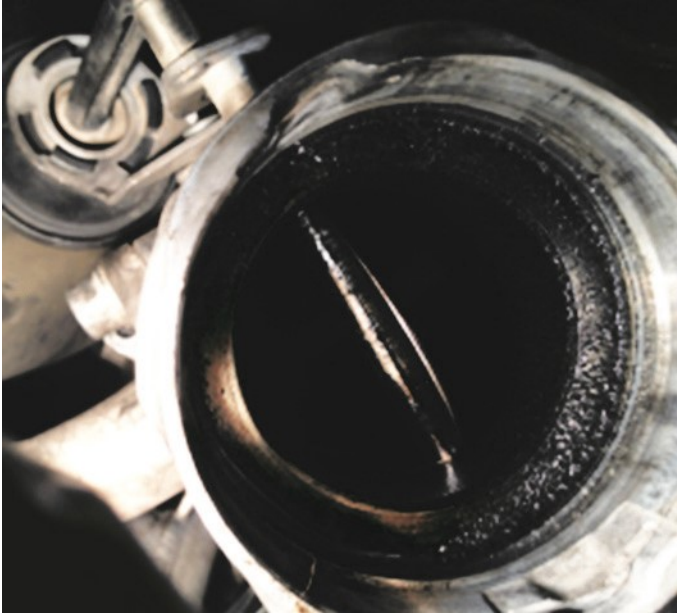
Afb. 4: Klep van het uitlaatgasrecirculatiesysteem (EGR-klep) verkoold
